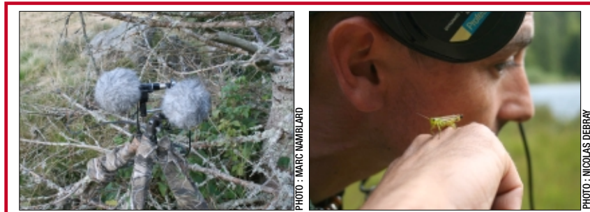
Dans la technique du piège à son, le micro (ou les deux micros comme ici en cas de stéréo) est laissé à poste fixe plusieurs jours pour permettre de récupérer des sons d'animaux représentatifs de leurs activités dans leur milieu. Posté à distance, l'ingénieur du son contrôle la qualité de ses enregistrements. Mais avant d'installer un micro, il faut écouter pour savoir où le placer idéalement.
